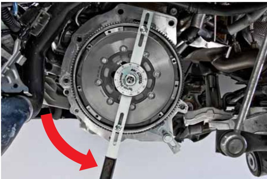
5. Sekundärschwungscheibe mit Hebel gegen den Uhrzeigersinn drehen, bis die Federkraft der Bogenfedern spürbar ist.
