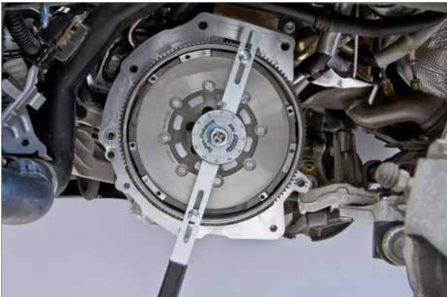
In wenigen Fällen liegt eine ungerade Anzahl an Befestigungsgewinden für die Kupplungsdruckplatte vor und man kann den Hebel nicht mittig montieren. In diesen Ausnahmefällen muss der Freiwinkel über die Zählung der Zähne des Anlasserkranzes ermittelt werden - siehe Kapitel 4.3.
