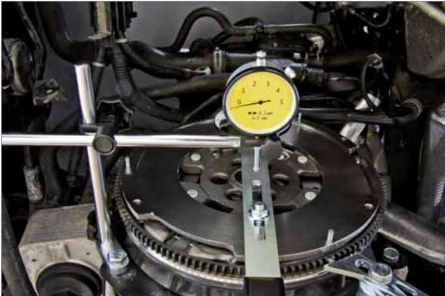
1. Messuhr mit dem Halter an Motorblock anbauen.
