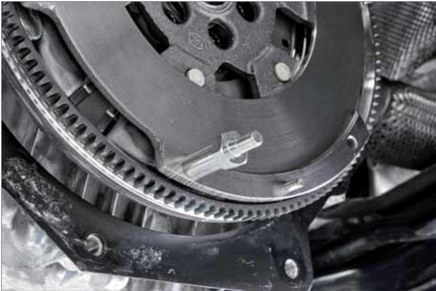
2. Entsprechende Adapter (M6, M7 oder M8) in zwei senkrecht gegenüberliegende Gewindebohrungen der Kupplungsbefestigung am ZMS einschrauben und festziehen.
