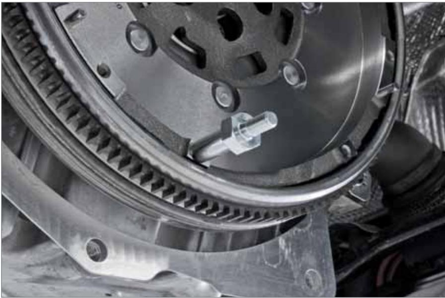
2. Entsprechende Adapter (M6, M7 oder M8) in zwei annähernd senkrecht gegenüberliegende Gewindebohrungen der Kupplungsbefestigung am ZMS einschrauben und festziehen.
