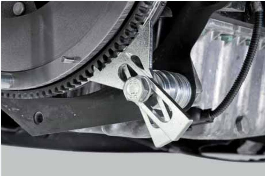
4. ZMS blockieren – Getriebeschraube und gegebenenfalls Distanzstücke verwenden um das Blockierwerkzeug auf der Höhe des Anlasserzahnkranzes zu befestigen.
