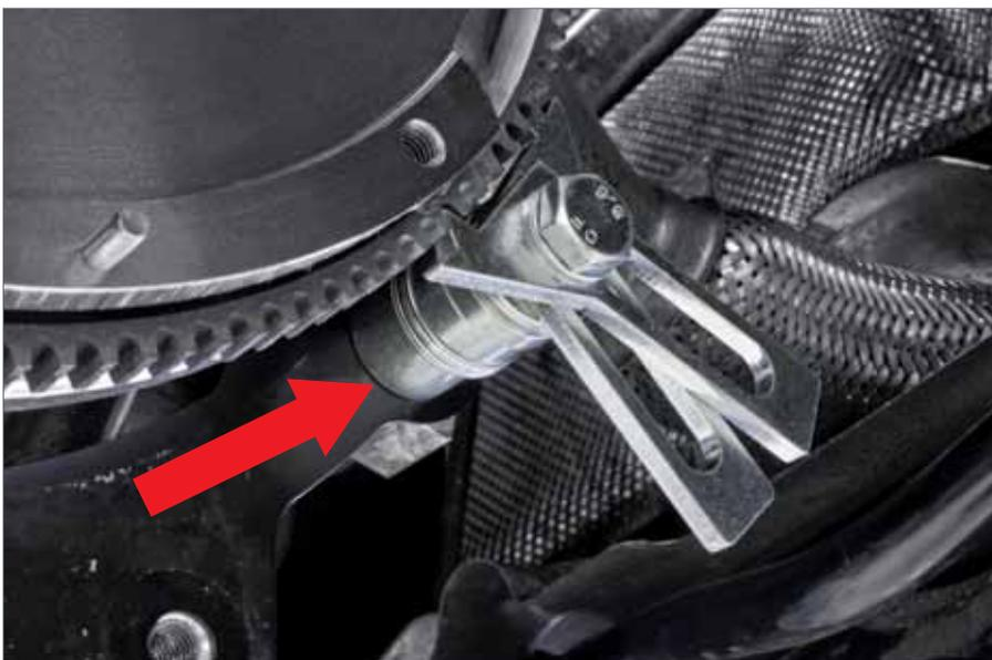
Ist eine Befestigung nur an einem Gewinde möglich, kann man mit Hilfe der beiliegenden Buchse die Passhülse umbauen.
