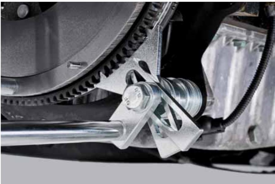
Eventuell kann auch das Blockierwerkzeug und der Messuhrenhalter zusammen an einer Schraube montiert werden.
