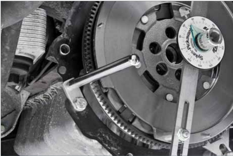
5. Messuhrenhalter am Motorblock montieren - Getriebeschraube und gegebenenfalls Buchse analog zum Blockierwerkzeug verwenden.
