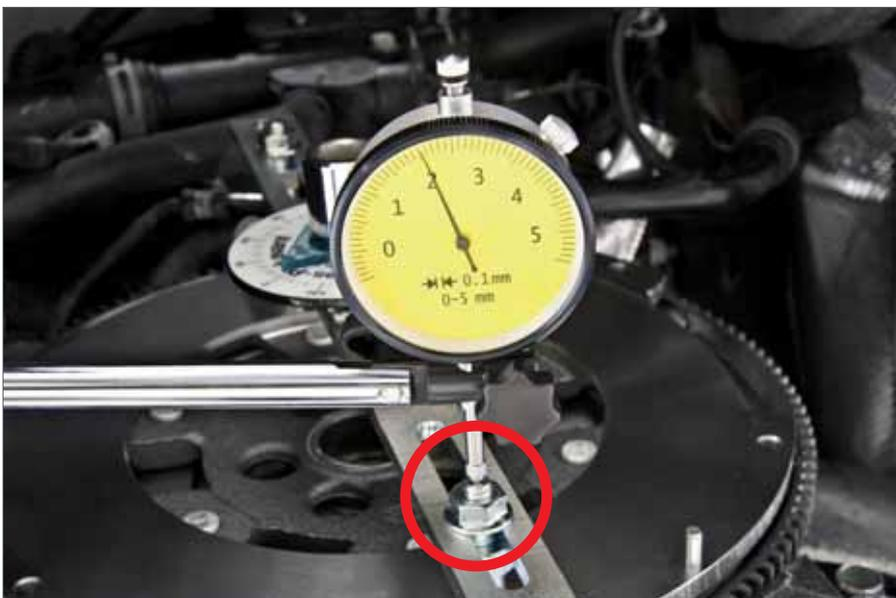
2. Messuhr mittig auf dem Adapter ausrichten und entsprechend vorspannen.
