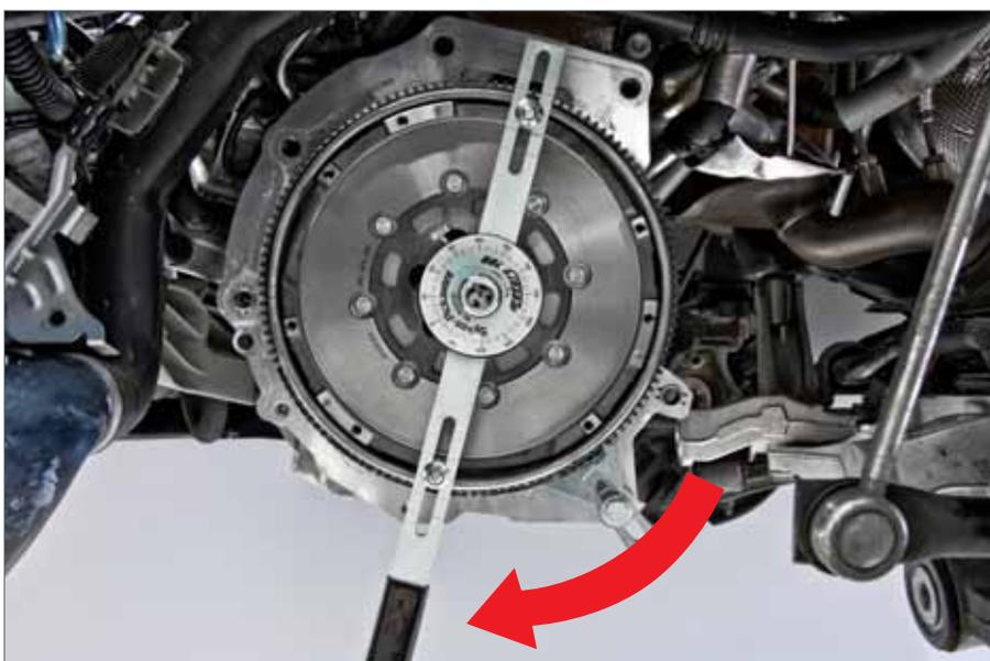
7. Sekundärschwungscheibe im Uhrzeigersinn drehen, bis die Federkraft der Bogenfedern spürbar ist. Hebel langsam loslassen, bis die Bogenfedern entspannt sind.
